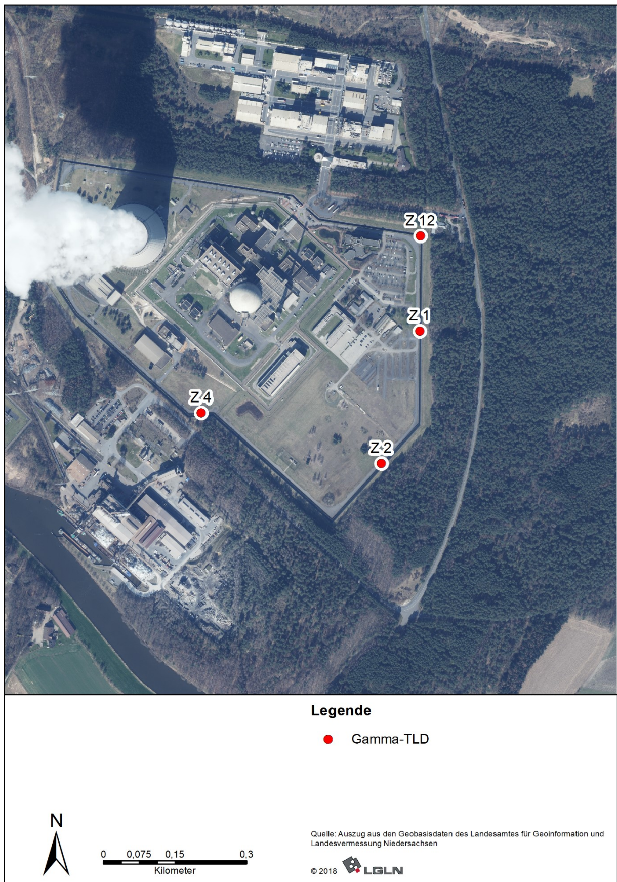
Abb. 2-1: Gamma-Ortsdosis-Messpunkte (MP Z 1, Z 2, Z 4 und Z 12) an der Betriebsgeländegrenze
