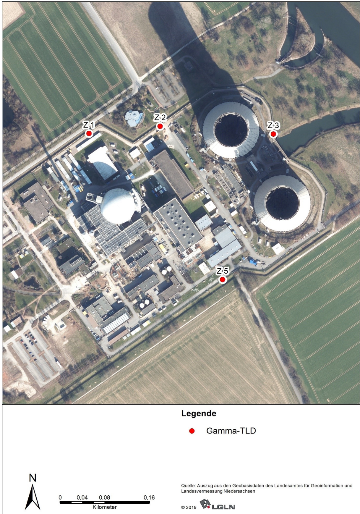
Abb. 2-1: Gamma-Ortsdosis-Messpunkte (MP Z 1 bis Z 3, Z 5) an der Betriebsgeländegrenze
