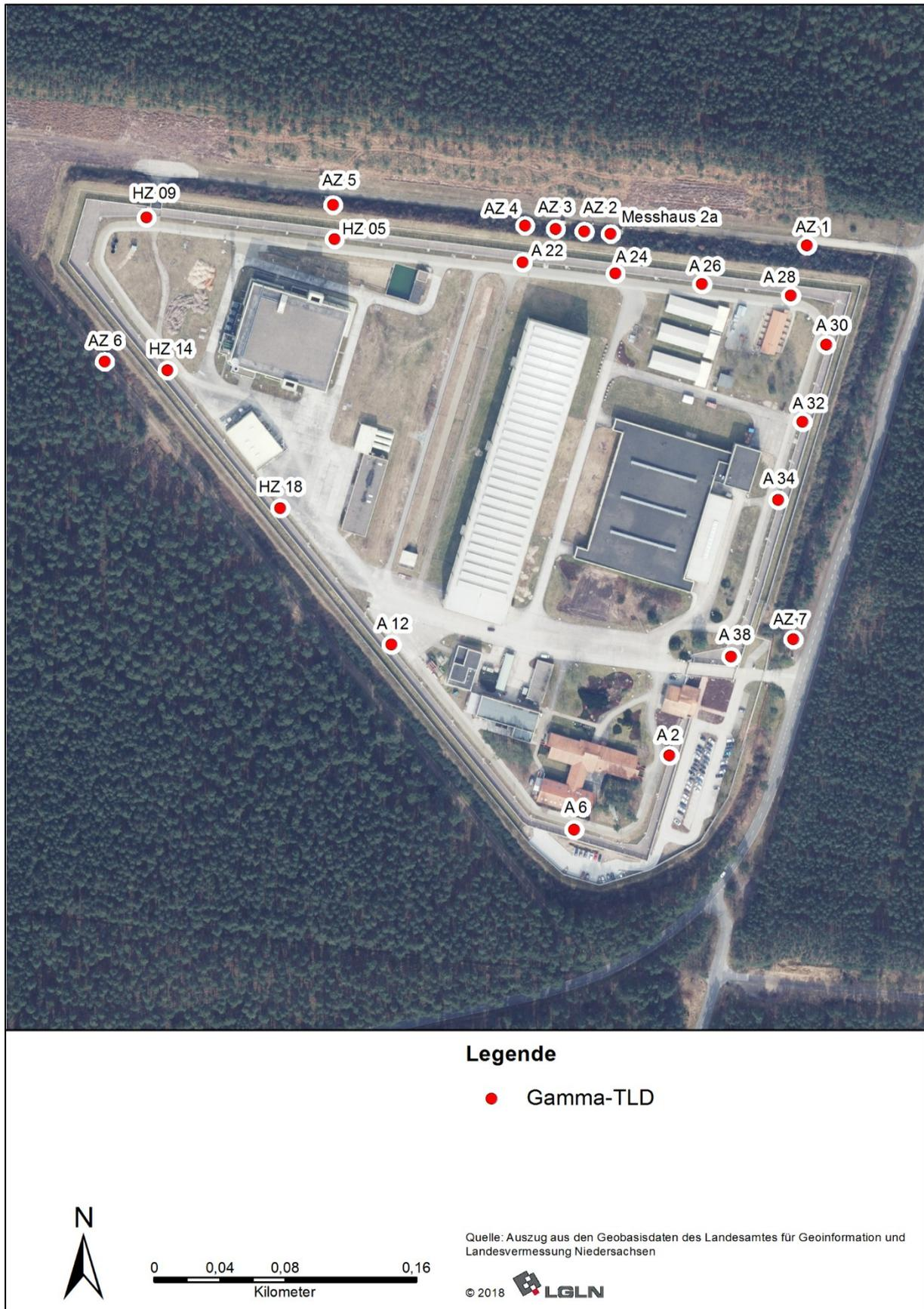
Abb. 2-1: Gamma-Ortsdosis-Messpunkte an der Betriebsgeländegrenze (MP AZ 1 bis AZ 7, A 2, A 6, A 12, A 22, A 24, A 26, A 28, A 30, A 32, A 34, A 38, HZ 05, HZ 09, HZ 14, HZ 18, Messhaus 2a)
