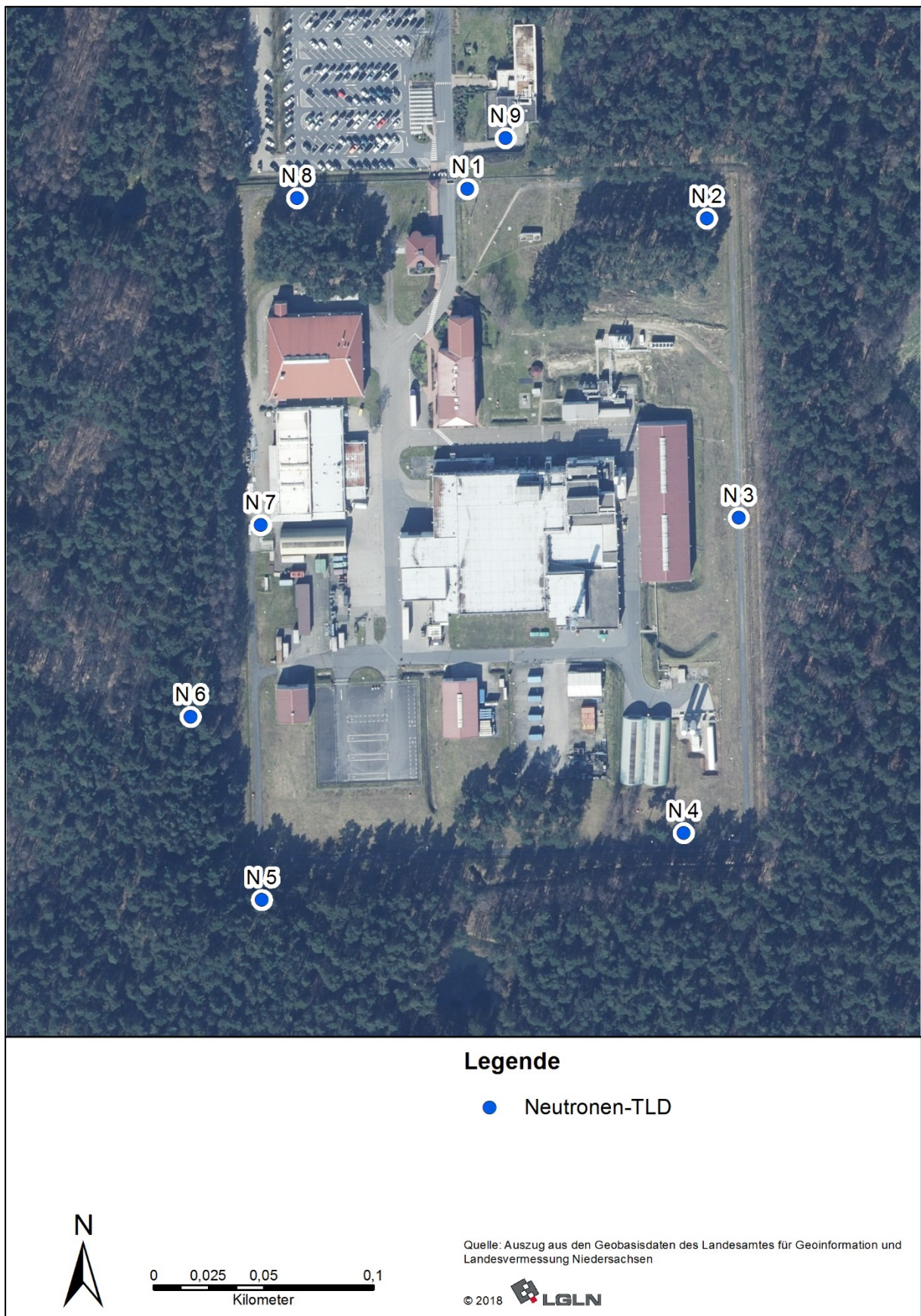
Abb. 2-2: Neutronen-Ortsdosis-Messpunkte an der Betriebsgeländegrenze (MP N 1 bis N 8) und am Referenzpunkt (MP N 9)
